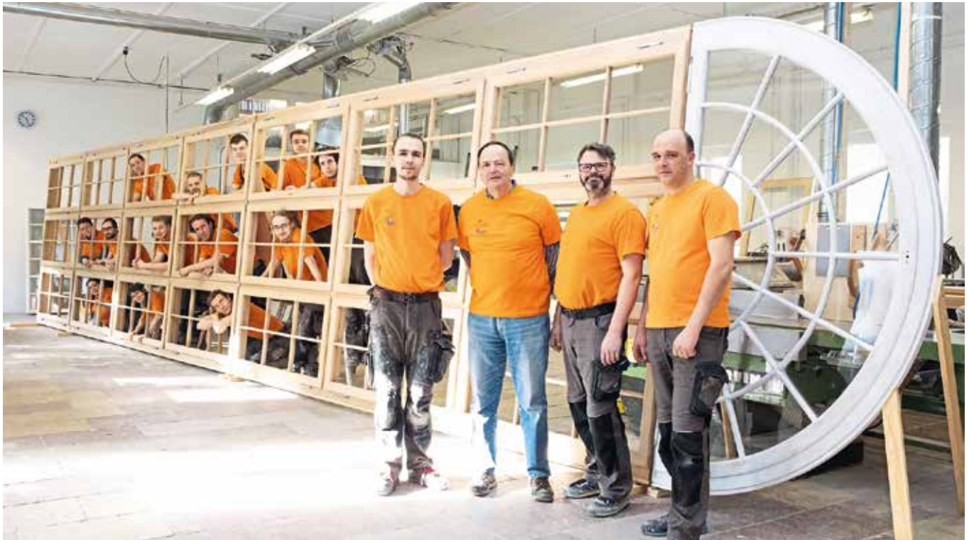
Firmenleitung und Mitarbeiter der Tischlerei Spatzier vor einem Kastendoppelfenster (2,6 mal 13 Meter) aus Eiche für den Wiederaufbau der Garnisonkirche in Potsdam.
